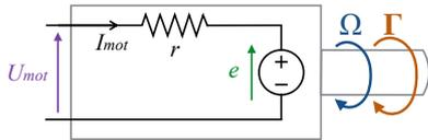
Les trois paramètres principaux d'un moteur sont: La constante de vitesse  $K_v$  (qui en unités SI est égale à sa constante de couple  $K_c$ ) sa résistance interne  $r$  et son courant à vide  $I_0$ . On peut trouver les relations entre la tension en entrée du moteur  $U_{mot}$ , le courant  $I_{mot}$  la vitesse de rotation  $\Omega$  et le couple  $\Gamma$  sur l'arbre en utilisant les équation du moteur et l'équation électrique.
